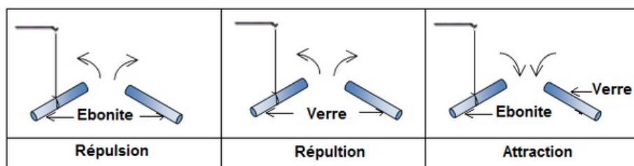
Il existe deux sortes d'électricité : l'électricité qui apparaît sur bâton de verre est positive (+) et celle qui apparaît sur l'ébonite négative (-).
