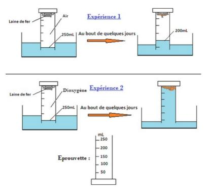
La laine de fer introduite dans une éprouvette humidifiée retournée sur une cuve à eau.
