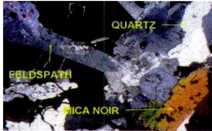
- Lame mince de granite observée au microscope polarisant.
