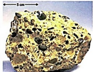
c - Conglomérat: Roche composée de galets cimentés entre eux.
