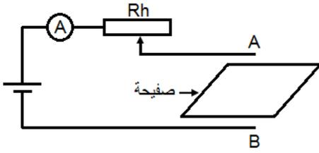
ننجز الدارة الكهربائية جانبه، وذلك باستعمال إما موصل مستقيمي أو موصل دائري أو ملف لولبي بين النقطتين A و B، ثم ننثر برادة الحديد على صفحة البلاستيك لمعاينة طيف المجال المحدث.
