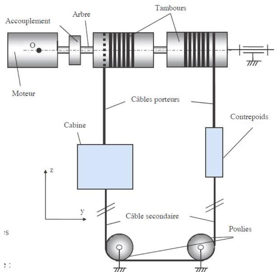
La cabine et le contrepoids sont reliés par un câble secondaire qui s'enroule sans glisser sur deux poulies d'axe parallèle guidées en rotation dans la partie basse de l'attraction.
