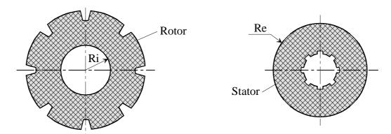
Les disques de friction sont en carbone pour des raisons de température de fonctionnement et de légèreté.
