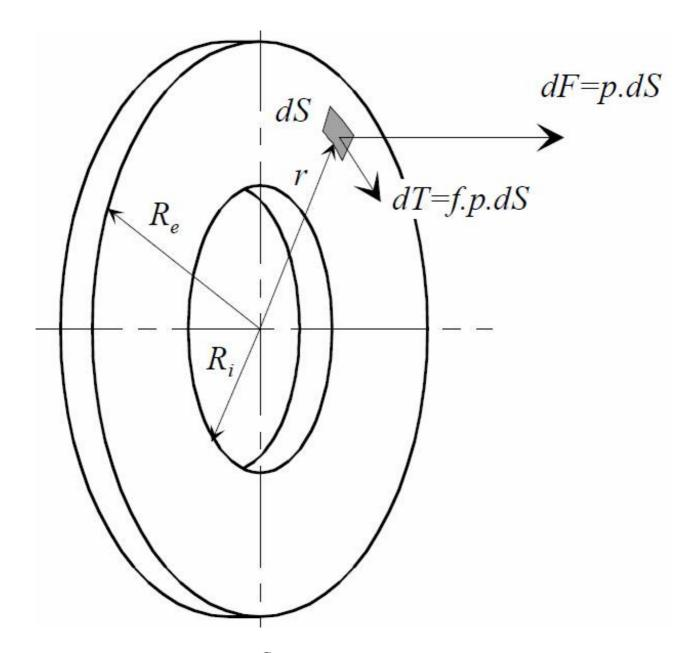
**6.** En déduire le couple total  $C_T$  exercé par les  $N_d$  disques du système de freinage d'une roue en fonction de  $P_h$  et des données géométriques et de frottement.
