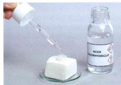
Fig. 2 : Acide chlorhydrique sur calcaire.
