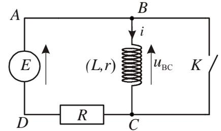
A l'instant  $t = 0$ , la bobine est mise en court-circuit, par la fermeture de l'interrupteur  $K$ .
