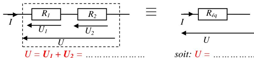
Donc :  **$R_{eq} = \dots\dots\dots$**       **En série, les résistances**  $\dots\dots\dots$
