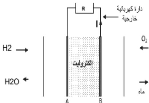
توضح التبيانة مبدأ الاشتغال الكهروكيميائي لعمود ذي محروق.
