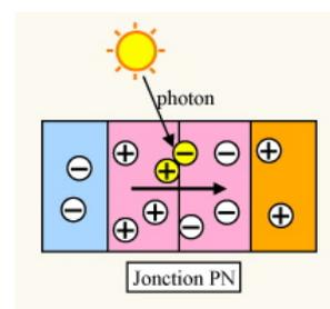
Lorsque les deux couches sont mises en contact, les électrons en excès de la couche n diffusent dans la couche p. Ainsi, la couche n se charge positivement, tandis que la couche p se charge négativement. Un équilibre se crée et un champ électrique interne apparaît.
