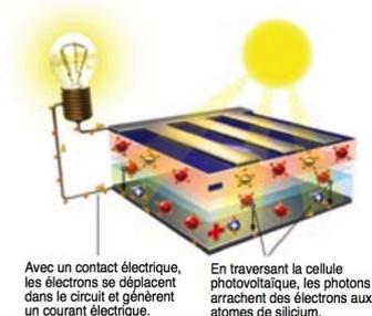
Un atome de silicium compte 4 électrons périphériques. La couche de silicium supérieure, dite couche n, exposée au Soleil, est dopée avec des atomes de phosphore possédant 5 électrons périphériques, soit un de plus que
