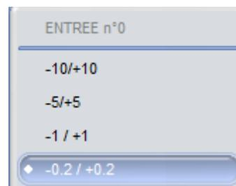
5. la tension induite étant de faible amplitude régler le calibre de la voie EAO sur +/- 0,2 V (voir photo ci contre) : cliquer droit sur EAO puis
