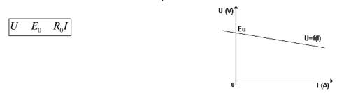
**E**<sub>0</sub>: tension à vide en volts, aussi appelée force électromotrice ou *f.e.m.*
