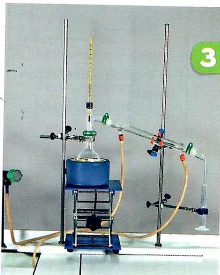
> Montage pour une hydrodistillation. Le support élévateur doit être réglé en position haute pour pouvoir éloigner rapidement le chauffe-ballon du ballon en cas de problème.
