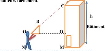
Les points  $\,C\,$  et  $\,A\,$  et  $\,C\,$  doivent être rectilignes  $\,d=\,OD=\,NM=\,8m\,$  la distance entre le bâtiment et la personne
