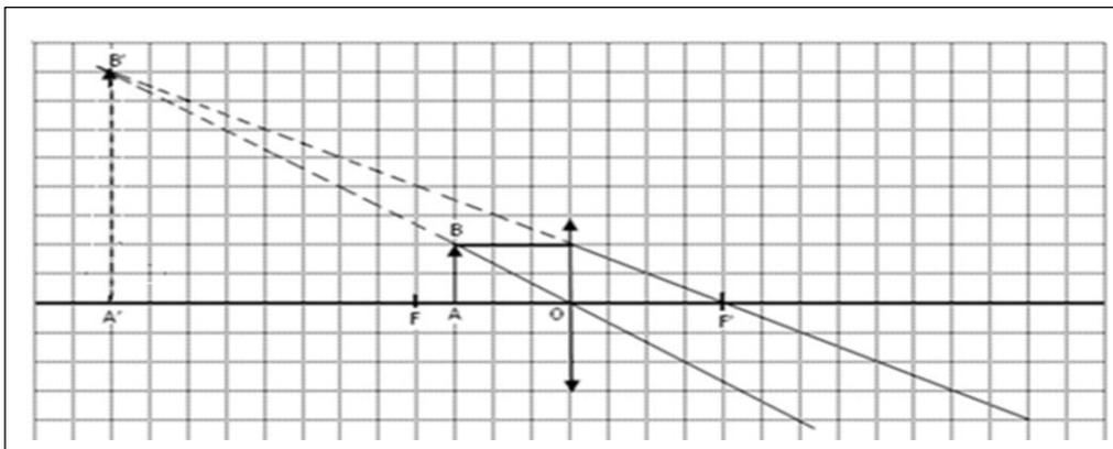
On obtient une image  $A'B'$  **virtuelle**, **droite** et **agrandie** lorsque on place l'œil derrière la loupe
