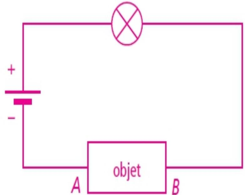
**Si la lampe s'éclaire alors le courant circule et la substance constituant l'objet est conductrice.**
