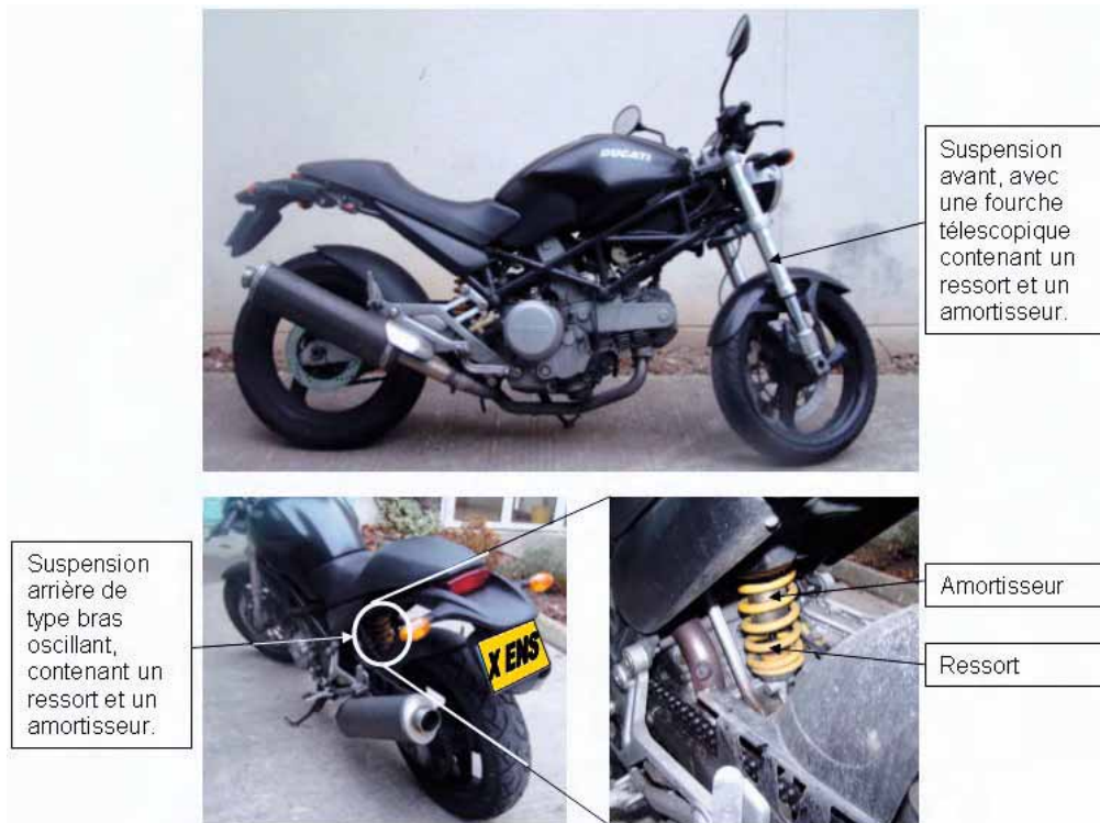
Illustration 14 : suspensions avant et arrière sur la Ducati Monster 620.
