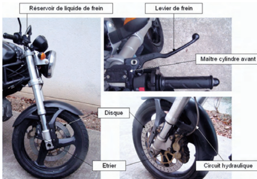
Illustration 8 : système de freinage sur la roue avant.
