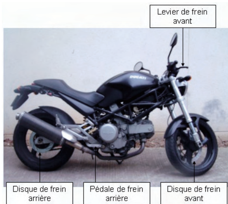
Illustration 6 : commande des systèmes de freinage sur la Ducati Monster 620.
