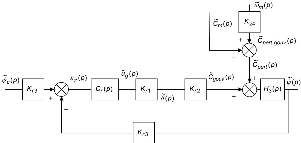
Figure 2 : Schéma-bloc de l'asservissement en vitesse de lacet
