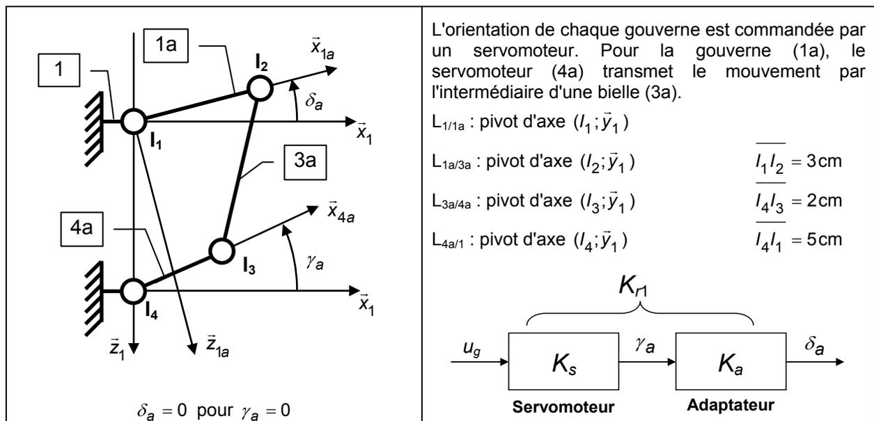
**Figure A6 : Modélisation du mécanisme de commande des gouvernes**
