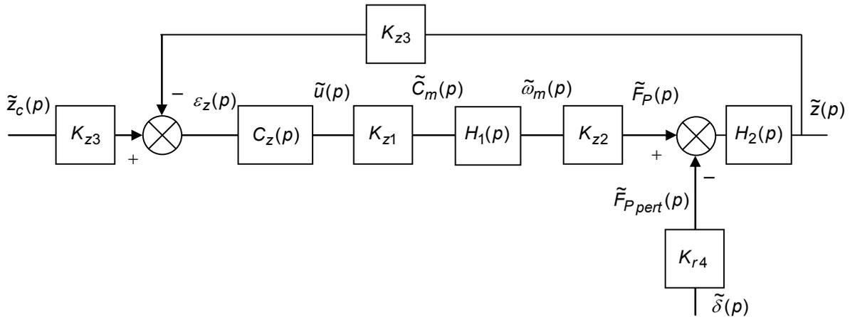
**Figure 3 : Schéma-bloc de l'asservissement en altitude**
