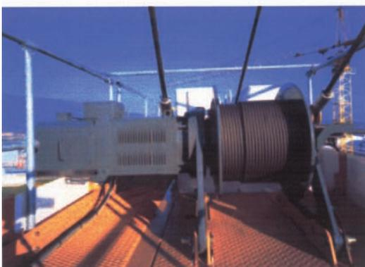
*Treuil de levage situé sur la contre flèche*
