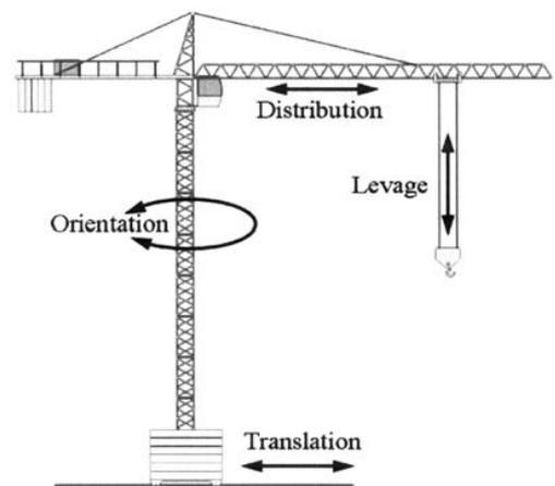
Figure 2 : Les 4 mécanismes d'une grue à tour
