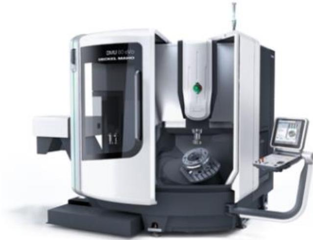
Un outil (fraise) est mis en rotation par un moteur et va usiner les surfaces de la pièce à travailler. Une table support sur laquelle est maintenue la pièce à usiner présente un mouvement d'avance permettant à l'outil de réaliser les surfaces voulues.
