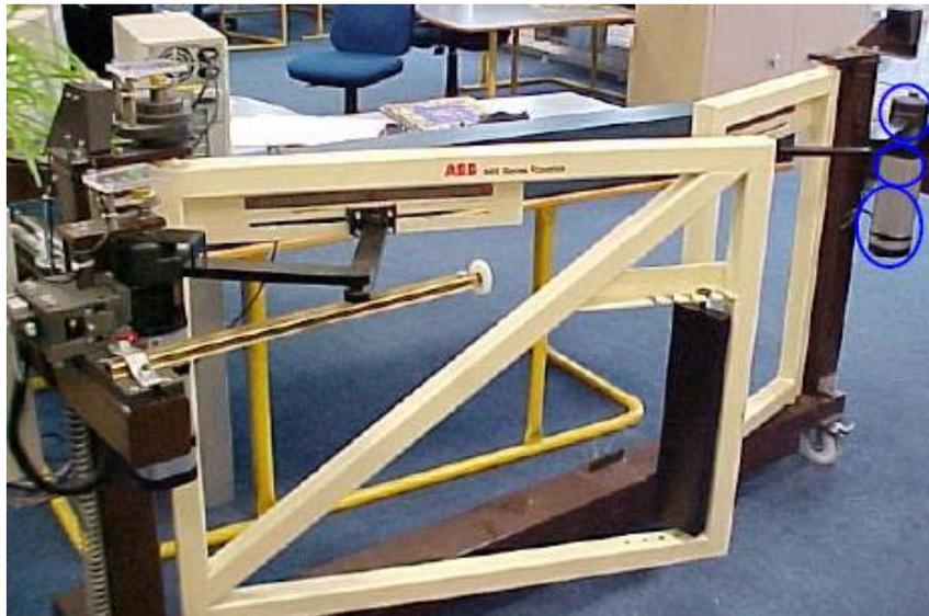
Notre objectif est de déterminer les contraintes dans le portail dans la situation réelle hyperstatique (encastrement de plusieurs poutres) afin de déterminer l'effort maximal que l'on peut exercer verticalement sur son extrémité sans le dégrader.
