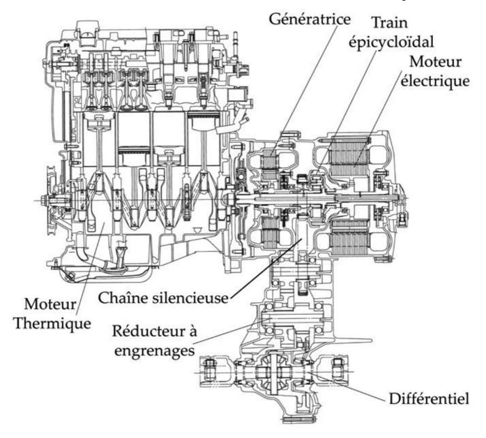
A partir de la position de la pédale d'accélérateur et de la vitesse du véhicule, le calculateur détermine la vitesse de rotation optimale du moteur thermique et la consigne d'ouverture du papillon des gaz.
