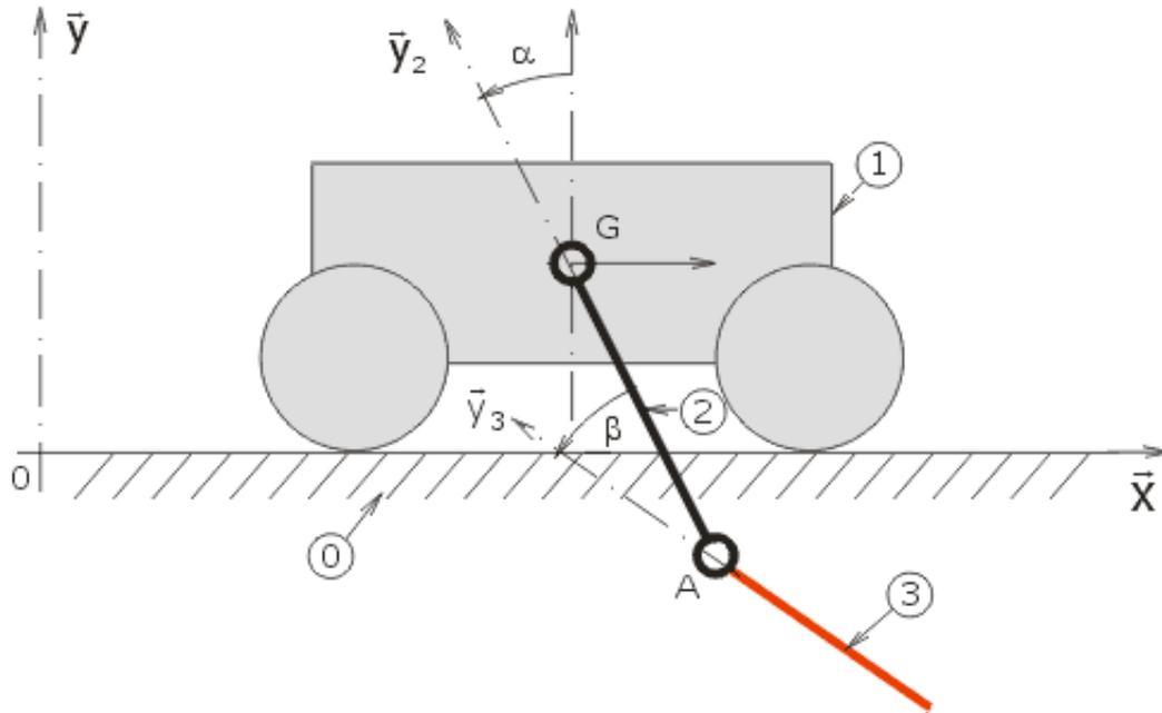
on pose:  $\vec{OG} = \left(\frac{1}{2} \gamma t^2\right) \vec{x} + h \vec{y}$  où  $a$  est une constante et  $t$  représente la variable temps.  $\|\vec{GA}\| = a$  et  $\|\vec{AB}\| = b$
