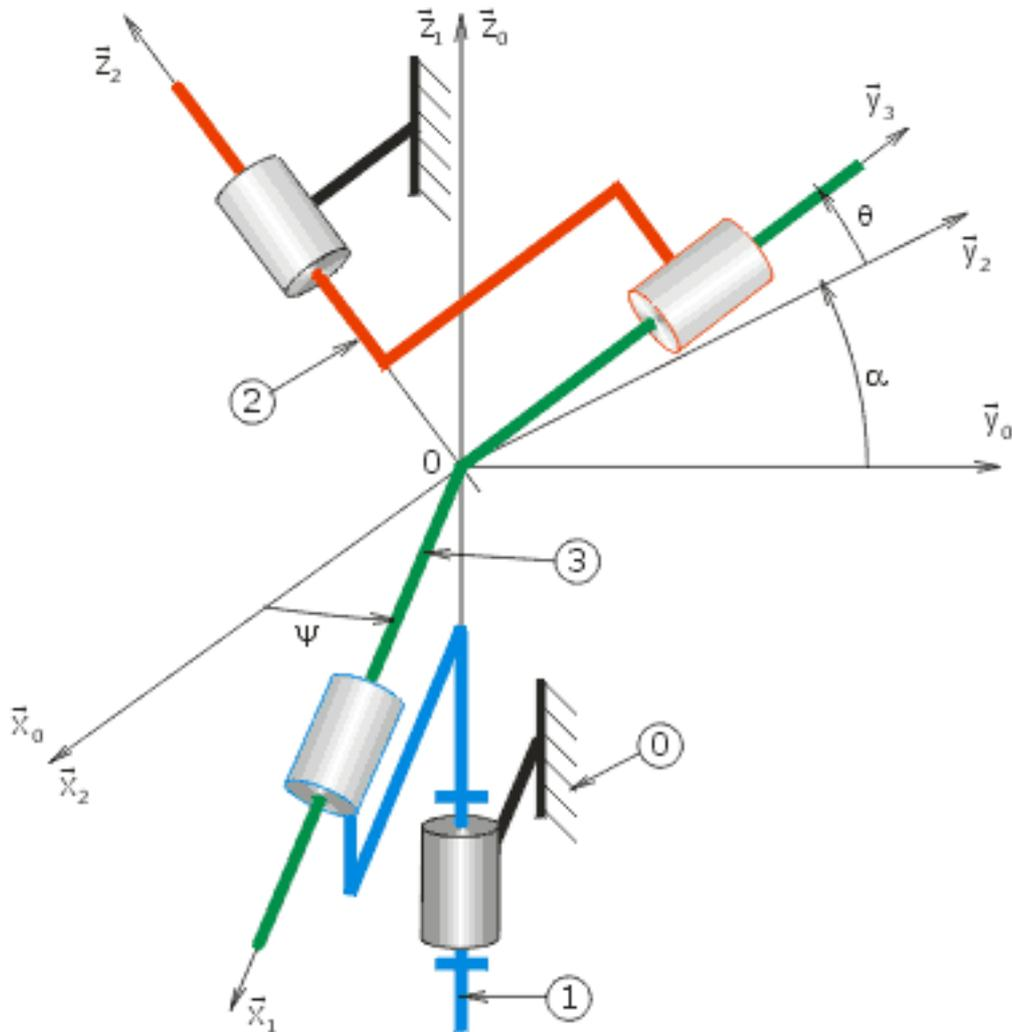
La rotation de l'arbre (1) autour de l'axe  $(O, \vec{z}_0)$  est caractérisée par le paramètre  $\Psi$ . Le paramètre de sortie qui caractérise la rotation de l'arbre (2) autour de l'axe  $(O, \vec{z}_2)$  est  $\theta$ . Les deux arbres se trouvent dans le plan  $(O, \vec{y}_0, \vec{z}_0)$ .
