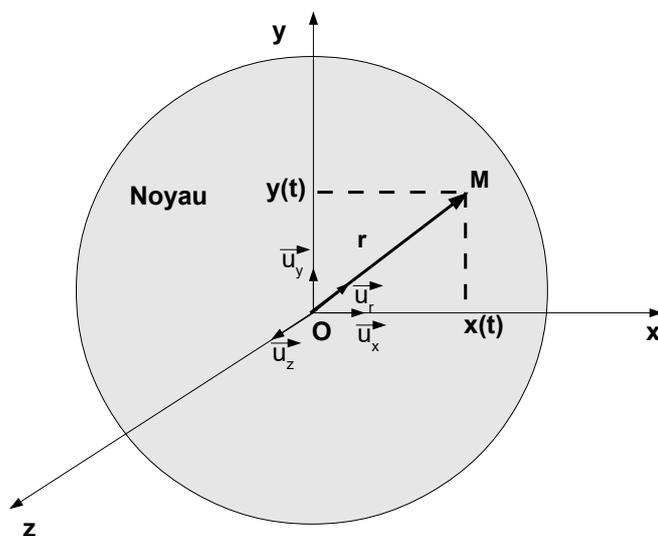
FIGURE 1 – Modèle de Thomson de l'atome
