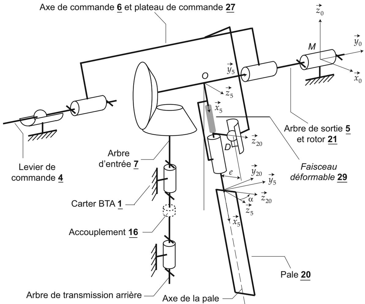
Ce schéma cinématique comprend une pièce déformable, le faisceau 29, et présente les bases associées aux pièces. La base  $(\vec{x}_0, \vec{y}_0, \vec{z}_0)$  est liée au fuselage-bâti, la base  $(\vec{x}_5, \vec{y}_5, \vec{z}_5)$  est liée à l'axe rotor, la base  $(\vec{x}_{20}, \vec{y}_{20}, \vec{z}_{20})$  est liée à la pale.
