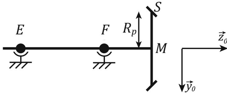
Document 7 – Schématisation du montage de roulements de l'arbre d'entrée 7.
