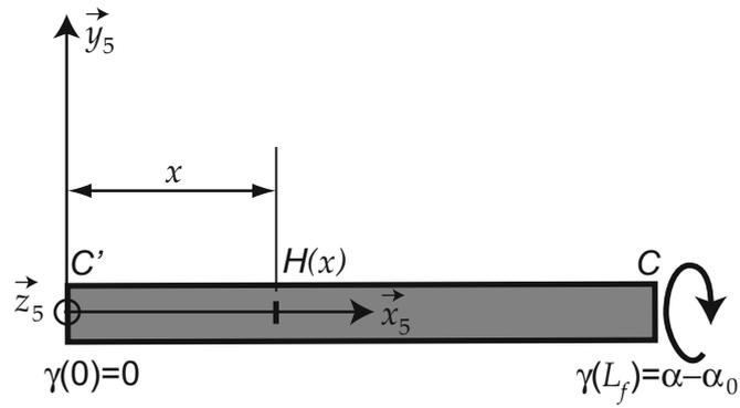
**Document 6 – Modélisation de la torsion du faisceau 29 générée par la commande de pas.**
