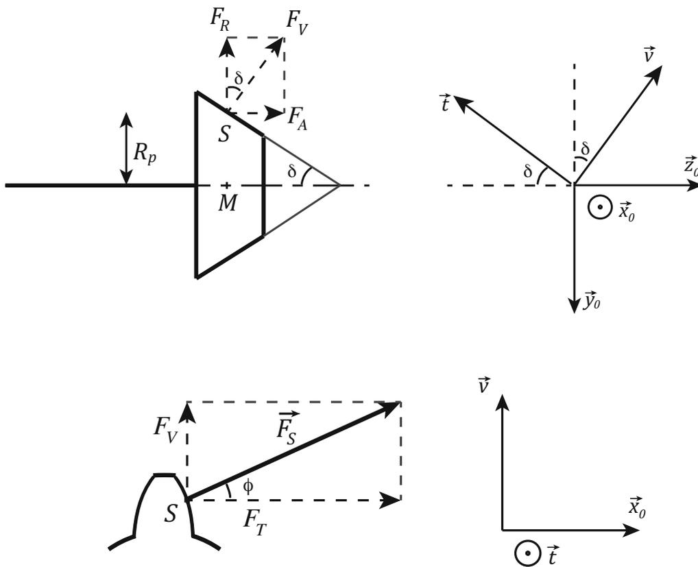
Document 8 – Schématisation de l'effort  $\vec{F}_S = F_T \cdot \vec{x}_0 - F_R \cdot \vec{y}_0 + F_A \cdot \vec{z}_0$  sur le pignon conique de l'arbre d'entrée, définition des composantes : radiale -  $F_R$ , tangentielle  $F_T$  et axiale  $F_A$  et des angles  $\phi$  et  $\delta$ .
