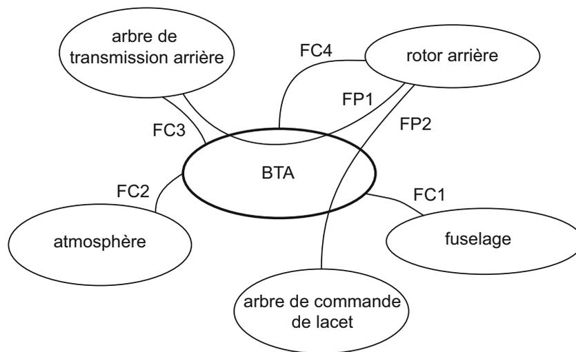
Figure 7 – Diagramme des interacteurs du système BTA
