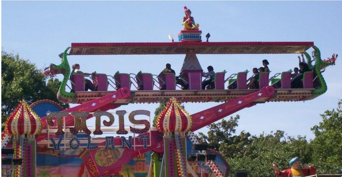
La nacelle dans laquelle prend place le public se déplace en translation circulaire par rapport à la terre du fait de la présence de deux « bras » parallèles de même longueur. Un moteur permet d'amener le « Tapis volant » en position vertical puis la gravité joue un rôle important afin d'effectuer des rotations lors desquelles la nacelle va vite en bas, et arrive en haut avec une vitesse presque nulle.
