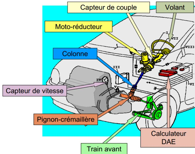
**Question 1:** Pour le système « Direction Assistée Electrique TWINGO » complet, construire le schéma topo fonctionnel montrant l'architecture de la chaîne d'information, de la chaîne d'énergie et de leurs échanges.
