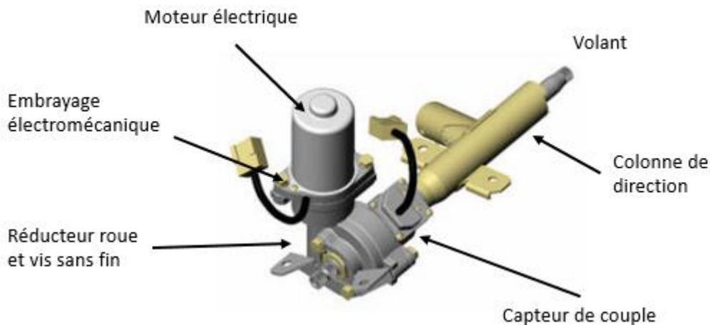
Le calculateur permet, à partir de paramètres mesurés par des capteurs sur le véhicule, de mettre en service le motoréducteur pour assister le conducteur dans ses manœuvres de parking ou à basse vitesse.
