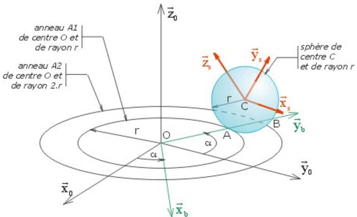
**1** On souhaite positionner le repère  $R_s (C, \vec{x}_s, \vec{y}_s, \vec{z}_s)$  lié à la sphère par rapport au repère  $R_0 (O, \vec{x}_0, \vec{y}_0, \vec{z}_0)$ .
