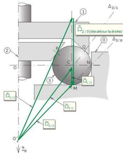
En  $O'$  on peut écrire:  $\vec{V}(O' \in 3/0) = \vec{0} = \vec{V}(O' \in 3/2) + \underbrace{\vec{V}(O' \in 2/0)}_{\vec{0}}$  car  $(O, \vec{z}_0)$  constitue l'axe central  $\Delta_{2/0}$  du mouvement de (2) par rapport à (0). De cette relation on déduit que  $\vec{V}(O' \in 3/2) = \vec{0}$ . Sachant que l'on a non glissement en P entre (3) et (2) ( $\vec{V}(P \in 3/2) = \vec{0}$ ), on déduit que l'axe central  $\Delta_{3/2}$  passe par  $O'$  et P.
