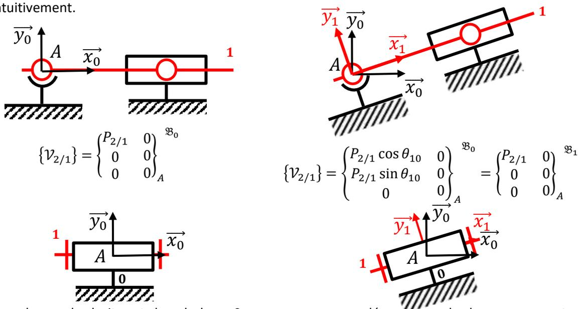
Dans le cas de droite, et dans la base 0, on remarque une dépendance de deux composantes en résultante (vitesse de rotation) et on remarque qu'un changement de base permet de supprimer celle-ci et de reconnaître une liaison pivot.
