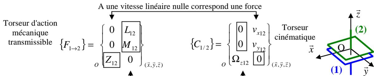
A une vitesse angulaire nulle correspond un moment non nul pour le torseur d'action mécanique transmissible
