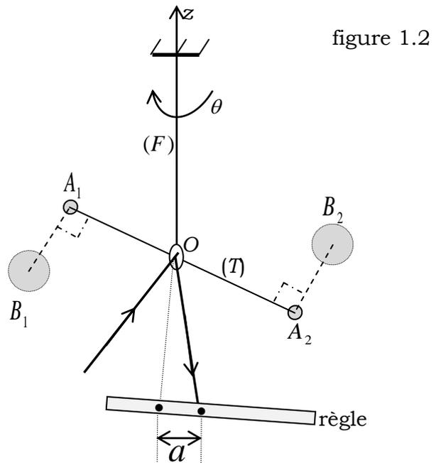
Lorsqu'on fait tourner la tige selon l'axe du fil d'un angle  $\theta$  (figure 1.1), on "tord" le fil. Lorsqu'on lâche la tige, le fil se "détord" en exerçant sur la tige un couple de rappel  $\Gamma = -C\theta$  où  $C$  est la constante de torsion du fil. On suppose qu'au repos, l'angle de torsion est nul.
