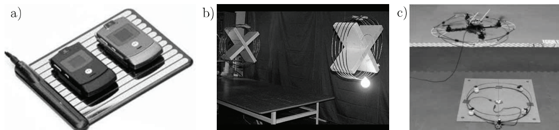
Figure 21 – Quelques expériences de transmission d'énergie sans fil : a) Recharge de téléphones portables ; b) Alimentation à distance d'une ampoule de 60 W (Source : compagnie Witricity) ; c) Dispositif de transmission sans fil entre un drone et un circuit au sol (Source : Université de Nebraska-Lincoln)
