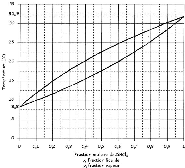
Figure 1 : Equilibre liquide vapeur du mélange  $\text{SiHCl}_3 - \text{SiH}_2\text{Cl}_2$  ( $P = 1,013$  bar)
