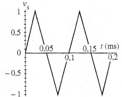
signal de sortie 10 kHz
