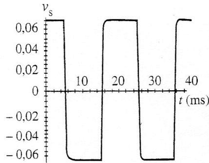
signal de sortie 50 Hz
