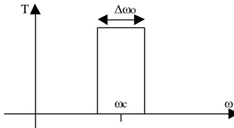
Etudier en fonction de  $\omega_c$  et en supposant que  $\Delta\omega_0 \ll \omega$  ( $\omega$  : pulsation fondamentale) l'influence d'un tel filtre sur le spectre de  $s(t)$ .
