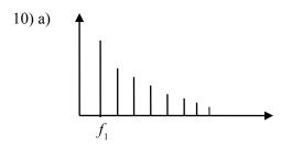
b) Compte tenu du critère proposé, le signal est défini par les 5 premiers termes de son développement, jusqu'au terme de fréquence  $9f_1$ . Si l'on impose  $9f_1 < f_0$ , il vient  $f_1 < \frac{f_0}{9}$  et  $T > \frac{9}{f_0}$ ; T > 0.9 ms
