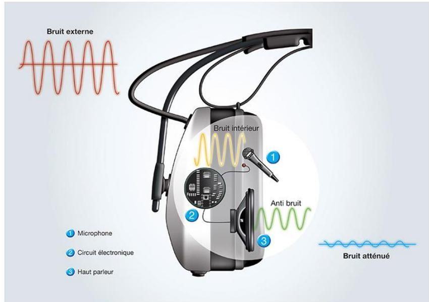
La société TechnoFirst® a développé la gamme de casques NoiseMaster® équipés de la technologie ANR® (Active Noise Reduction®). La technologie ANR® repose sur un système électronique miniaturisé (2) placé à l'intérieur de la coquille du casque. Ce système est connecté d'une part à un petit microphone (1) qui capte le bruit ambiant et d'autre part à un petit haut-parleur (3) qui génère le « contre bruit » à proximité de l'oreille de façon à atténuer considérablement le bruit qui arrive au tympan.
