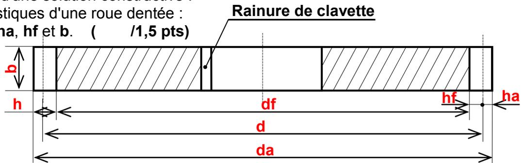
b- La condition d'engrènement de cet engrenage : **Même module "m"** ( /0,5 pts)
