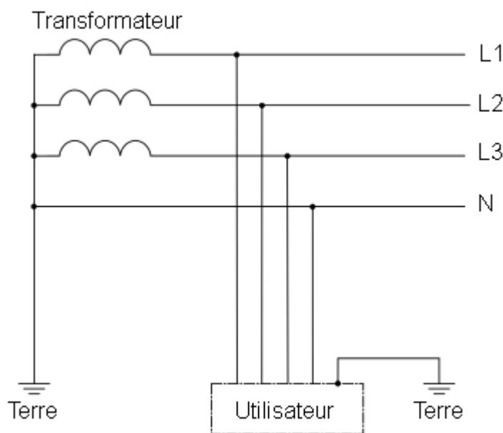
ce raccordement est utilisé par ONE pour les distribution basse tension publique
